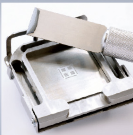
將錫膏均勻的塗佈在印刷鋼板上
